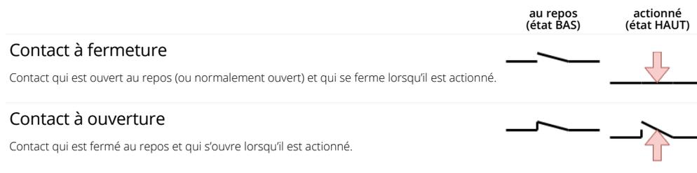
Un contact est à l'état 0 en l'absence d'action physique sur celui-ci, et à l'état 1 s'il est actionné.
